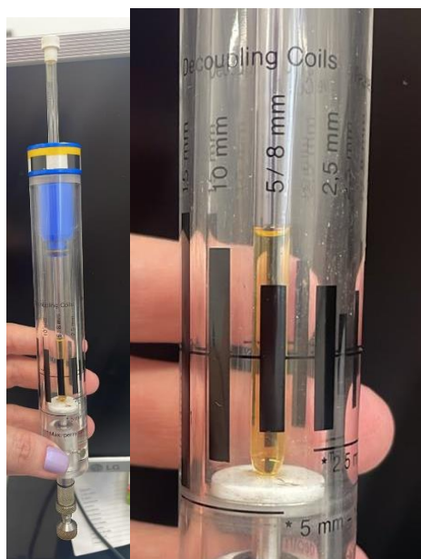
Medidor do 500 MHz com spinner e amostra em um tubo de 5 mm
